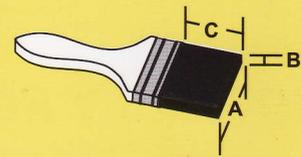
Fabricada con filamentos cilíndricos color negro mezcla de Nylon y 6/6 con PP, adheridos con pegamento epóxico de alta resistencia a los solventes, mango de plástico color verde, virola de lata estañada.
